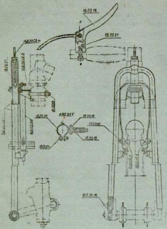
Рис. 5. Тормоз передний.
