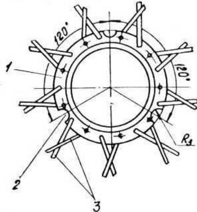
Фиг. 17. Схема расположения пропилов на буртике втулки:
