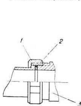
Фиг. 20. Соединение глушителя с выхлопным патрубком цилиндра (сеч. по д-д, фиг. 19):
