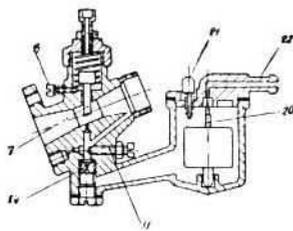
Карбюратор (фиг. 12) состоит из корпуса 4, крышки поплавковой камеры 19, поплавка 16 с иглой 20, дросселя 7 и жиклера 14. Топливо из топливного бака через фильтр топливного краника по топливопроводу поступает самотеком к ниппелю крышки 19 и заполняет поплавковую камеру. Постоянный уровень топлива в поплавковой камере поддерживается поплавком с иглой. Конус иглы, упираясь в седло крышки поплавковой камеры, образует игольчатый клапан.
