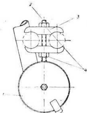
Фиг. 21. Крепление глушителя к вилке рамы велосипеда (вид по стрелке Б, фиг. 19):
