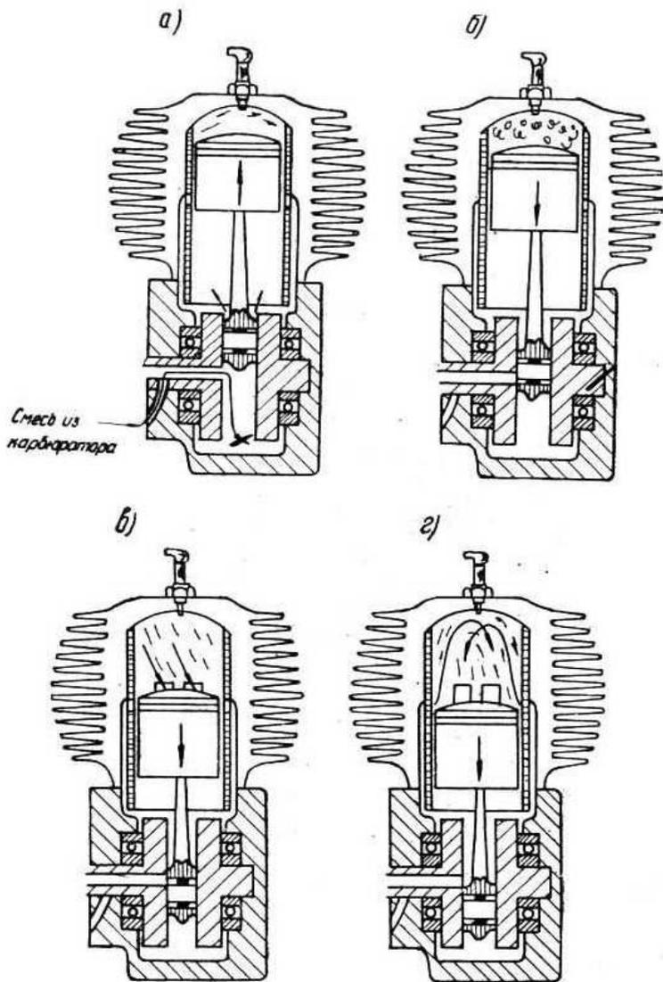
Фиг. 15. Схема работы двухтактного двигателя Д4.
