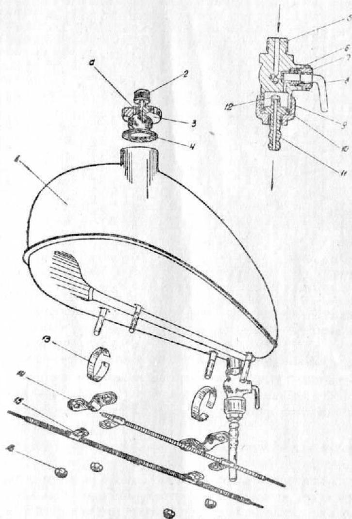
Фиг. 11. Топливный бачок с краником:
