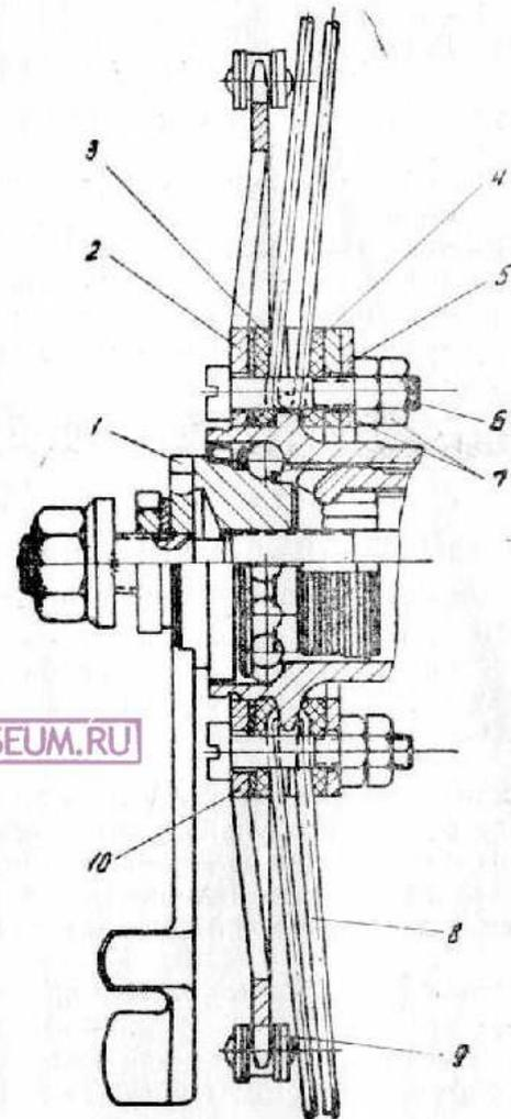
Фиг. 16. Крепление зубчатки на втулку заднего колеса:
