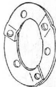
Фиг. 17. Схема расположения пропилов на буртике втулки: 1 — втулка; 2 — пропил; 3 — спицы.
