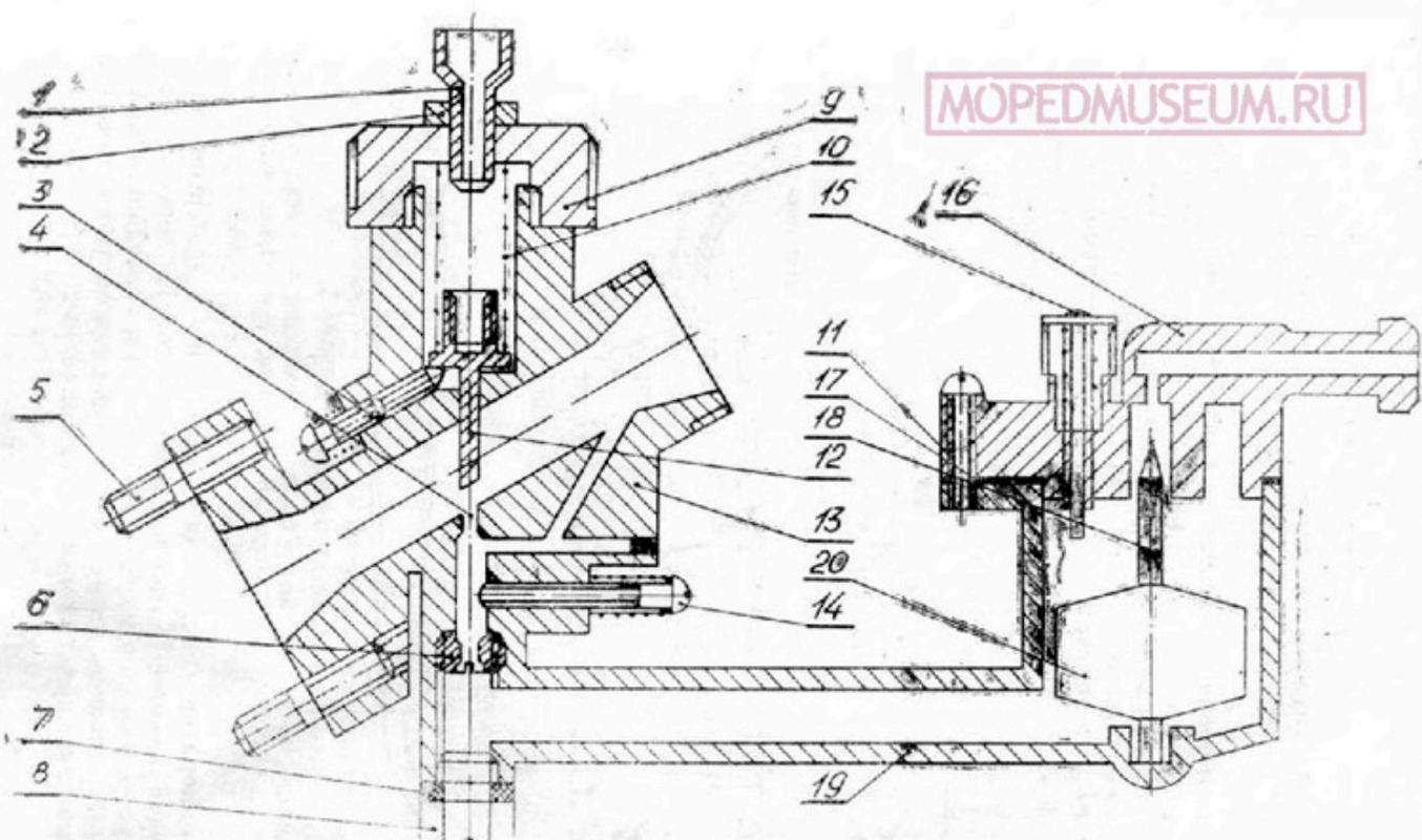
Рис. 6. Схема карбюратора К34Д
