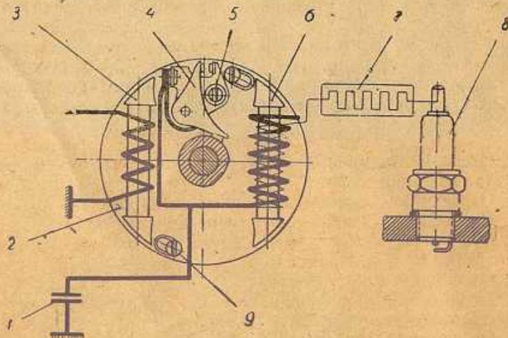
Рис. 6 — Схема зажигания.
