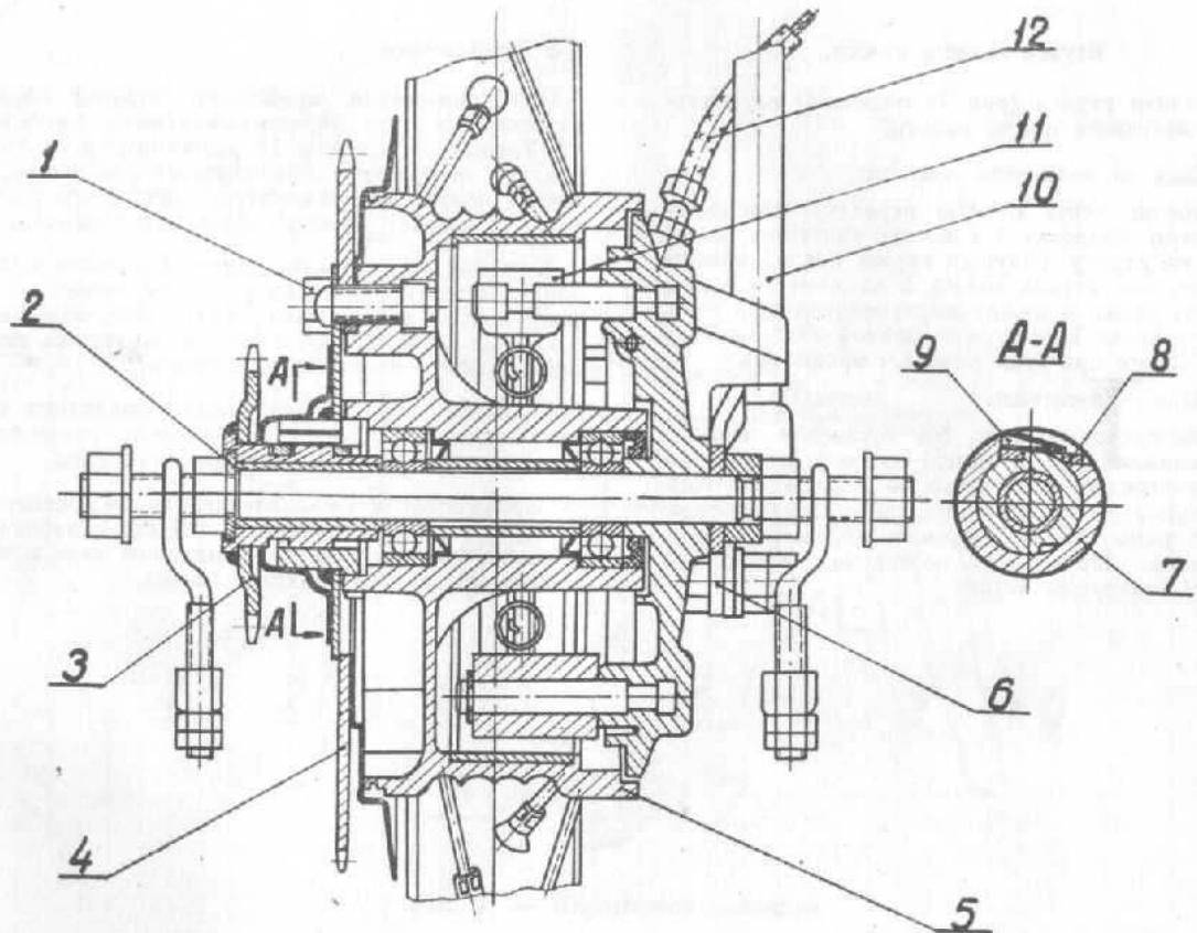
Рис. 7. — Заднее колесо.
