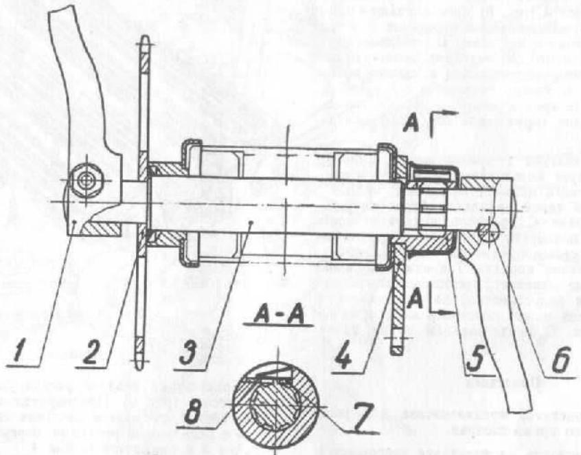
Рис. 8. — Кареточный механизм.
