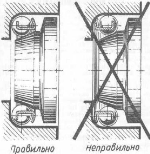
Рис. 13. Установка подшипниковых сепараторов.
